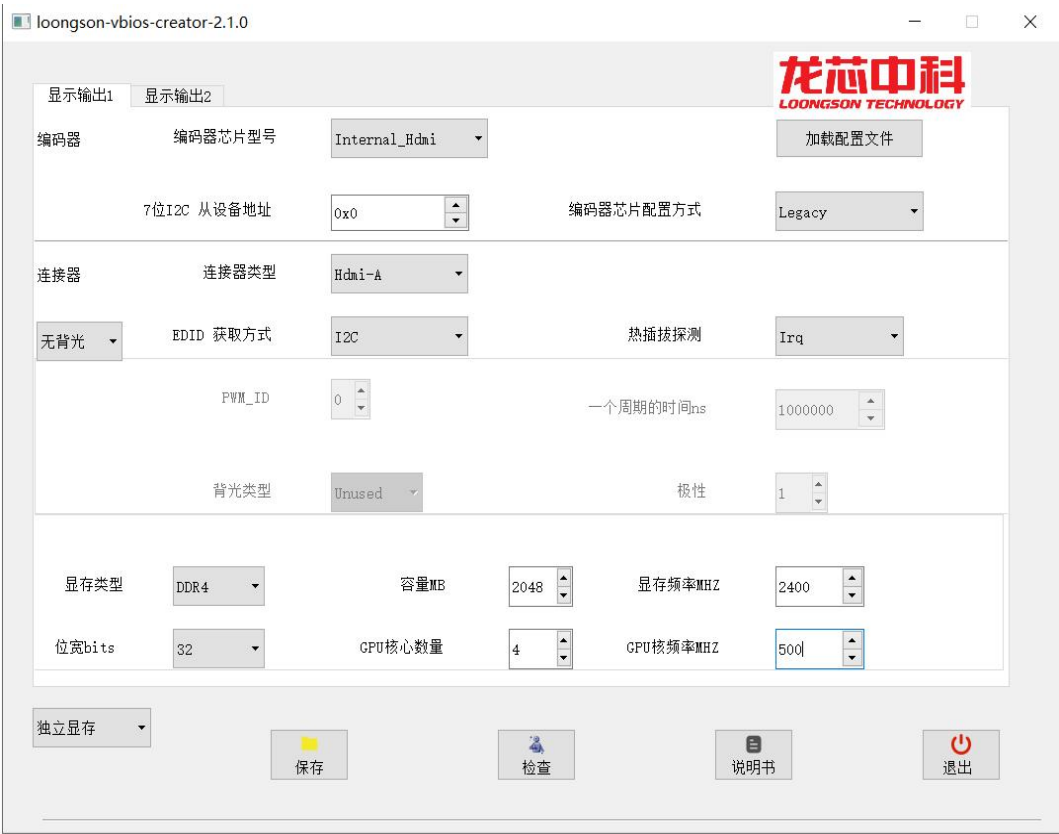
图 8-1 HDMI 连接方案
