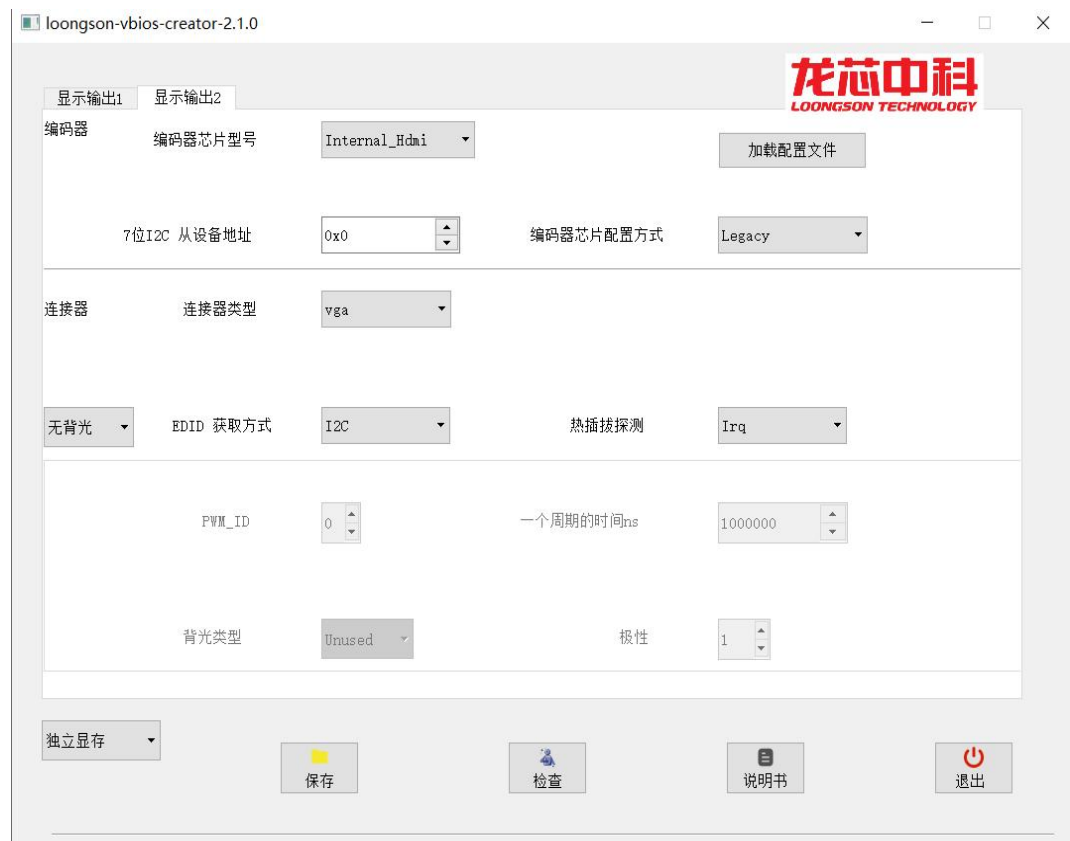
图 8-2 VGA 连接方案
